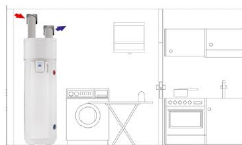
Instalacja w pomieszczeniu nieogrzewanym (kubatura >20 m 3 )
